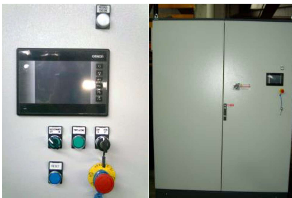
Figura 2a – Quadro comandi principale con terminale operatore con pannello touch screen
