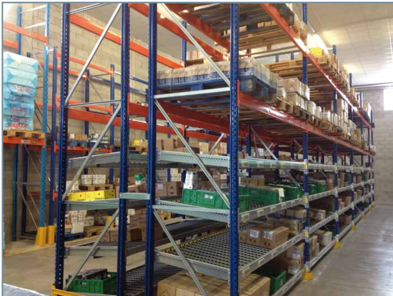
Impianto scaffalatura con rulliere picking
