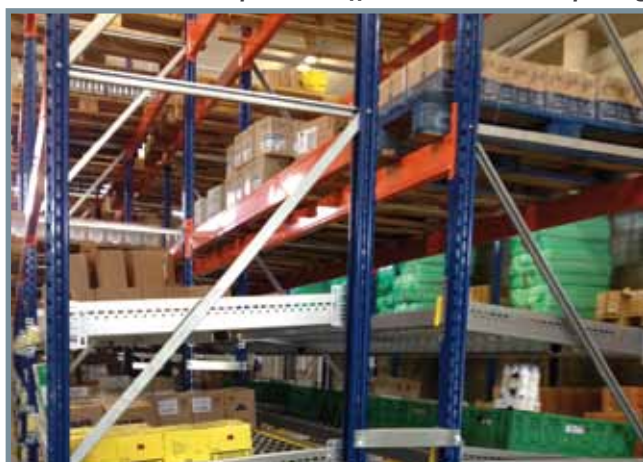
Impianto scaffalatura con rulliere picking
