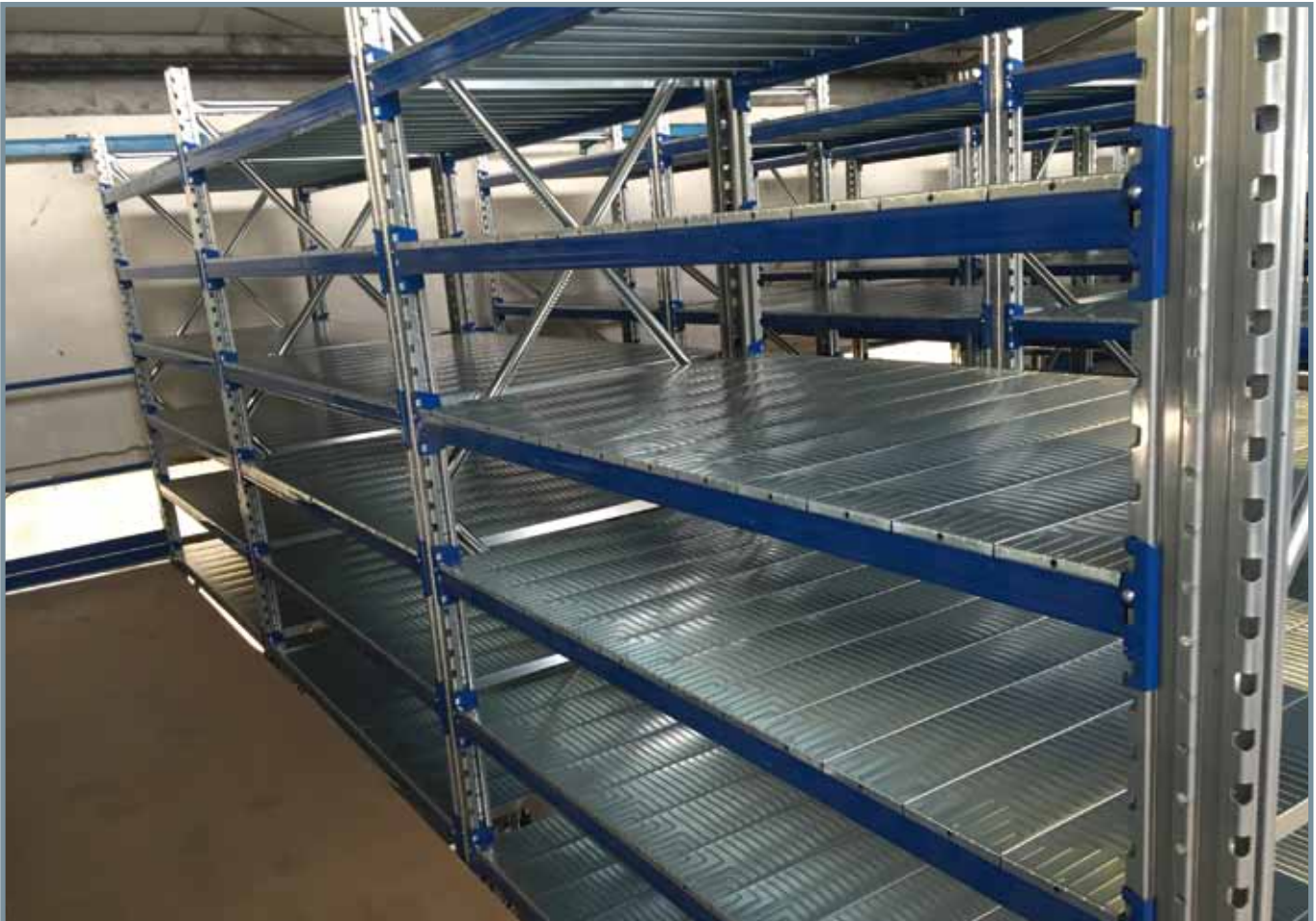
Impianto scaffalatura portapallet con pianetti zincati
