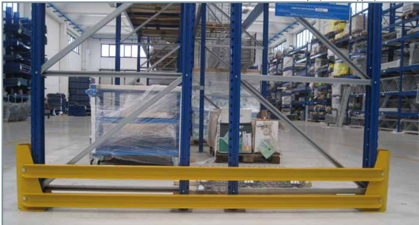
Scaffalatura con rompitratta
